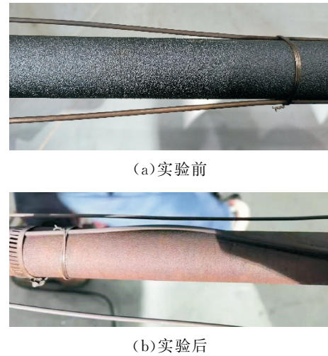
图 16 20 碳钢多孔管实验前后对比
